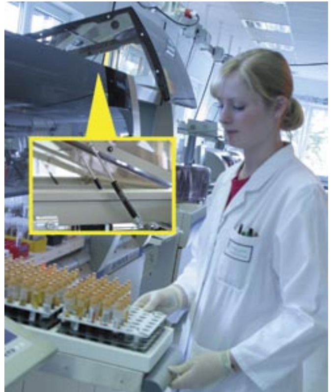
OLA2500 registreert, controleert en vindt alle gangbare proefbuisjes en sorteert ze in een soort schuiflade.
