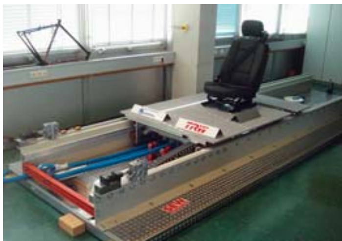
Noch mehr Bremskraft und Sicherheit für die Endlagen nach Integration einer Traverse und Installation des ACE Dämpfers mit M64x2 Gewinde und 150 mm Hub
