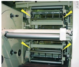
Vier ACE Industrie-Stoßdämpfer vom Typ Magnum ermöglichen in diesem automatischen Zweifach-Wendewickler den schnellen Wechsel von einer Folienwickelrolle zur nächsten.
