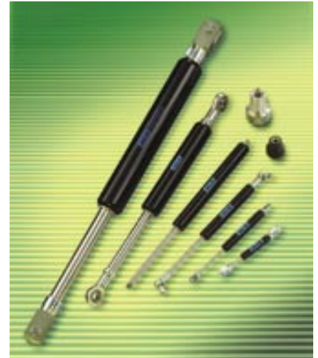
Bild 2: Die wartungsfreien Gasfedern mit Körperdurchmessern von 8 mm – 70 mm und Kräften von 10 N bis 5 000 N bieten höchste Standzeiten u.a. durch eine keramische Härteschicht auf der Kolbenstange
