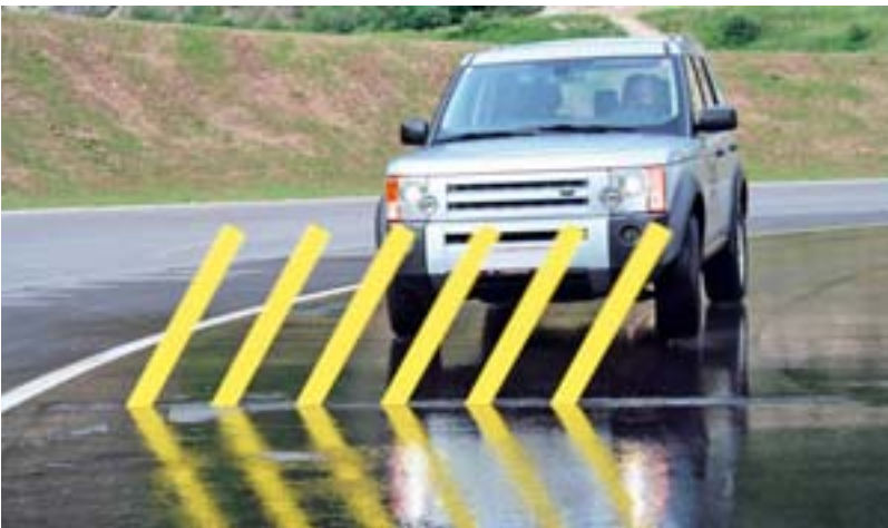
Mechanisches Hindernis MH08 mit stoßgedämpften Schwenkfahnen: Auf internationalen Übungspisten zuverlässig im Einsatz, hier im Fahrtechnikzentrum Saalfelden in Österreich
