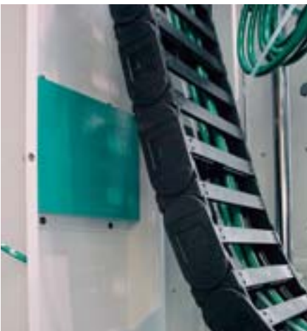
Moderne Dämpfungsplatten der D-Serie von ACE-SLAB schützen Kabelkanal und Gehäuse der Bearbeitungszentren vom Typ BAW04 und BAW06 der Schwäbischen Werkzeugmaschinen GmbH
