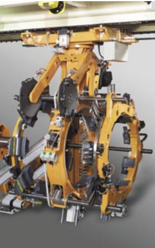
Bild 3: In der Transferstation mit Transferring kommen Stoßdämpfer zum Einsatz
