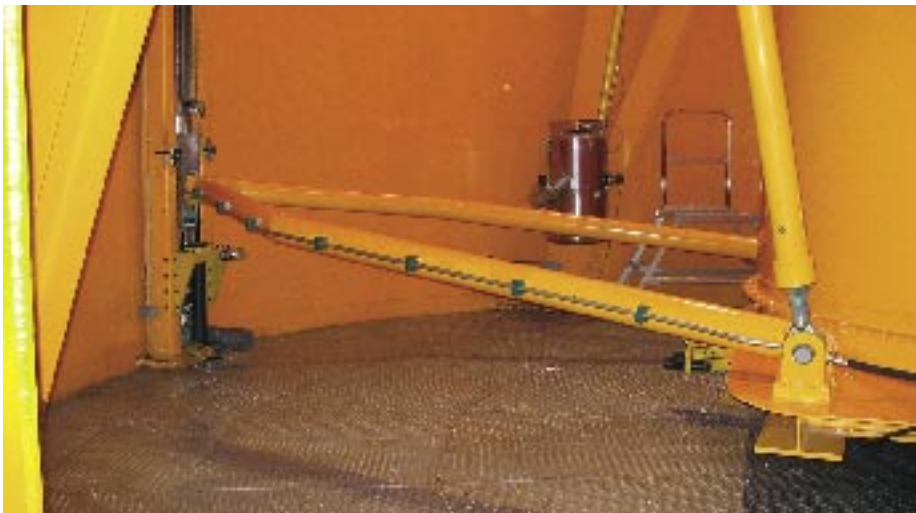
Bild 3: Einbaulage der Stoßdämpfer in die Einschwenvorrichtung des Abbremsbehälters
