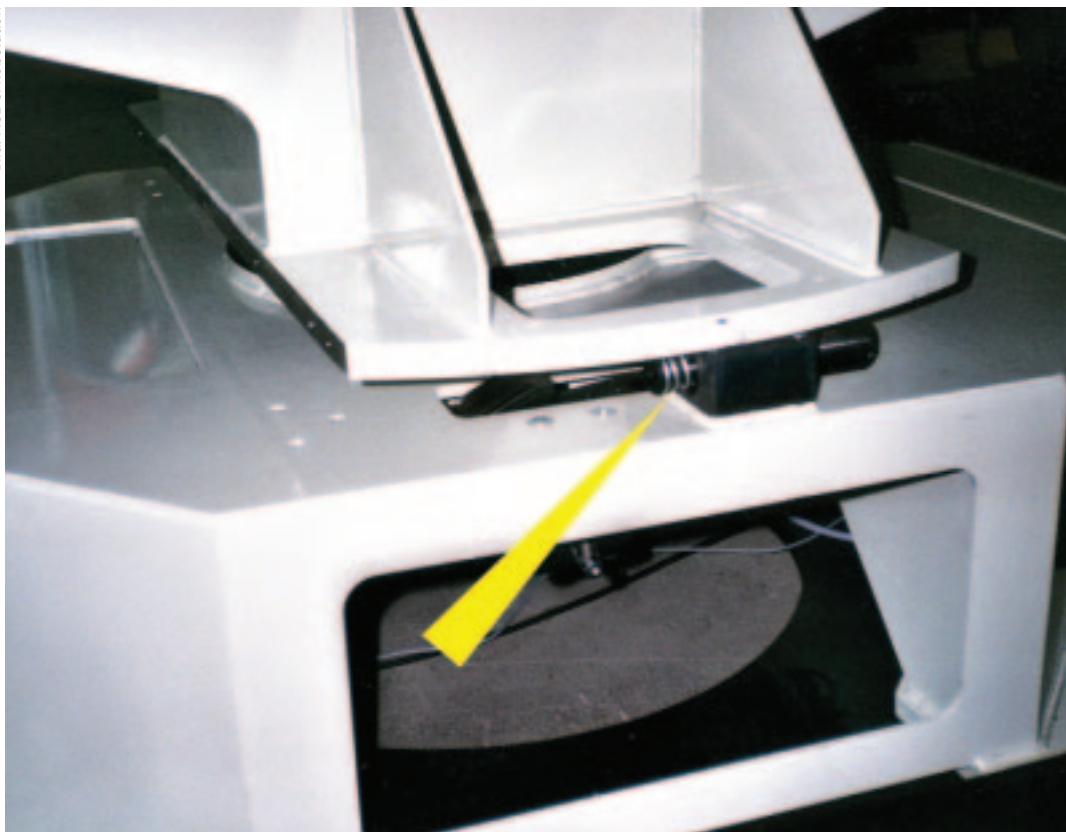
Sicher gebremster Drehtisch durch Industrie-Stoßdämpfer (gelber Pfeil).
