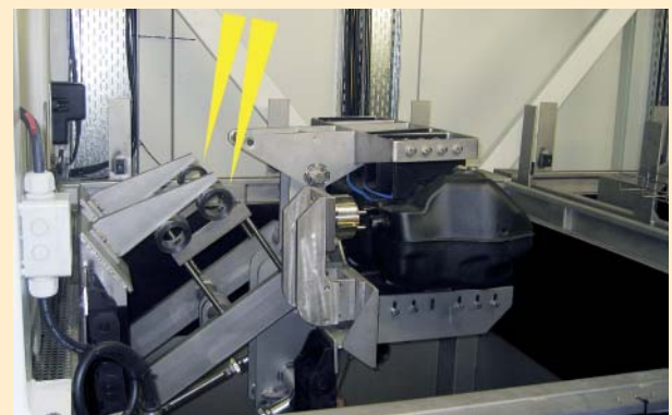
Sparsame Endlagendämpfung am Hydraulikantrieb
