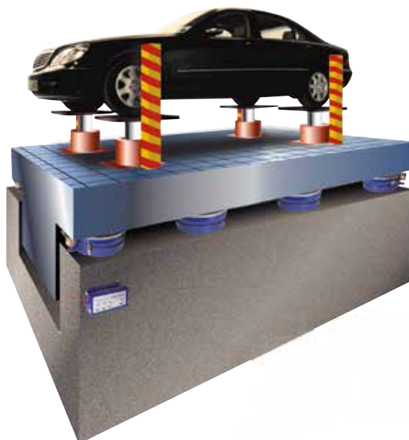
Prüfstände, Beispiel Straßensimulationsprüfstand
