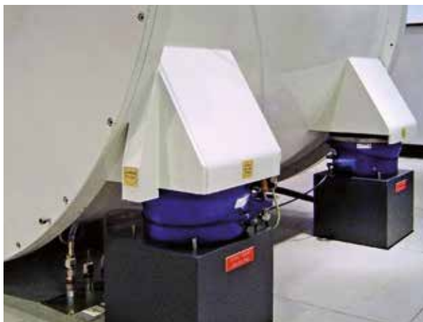
Beispiel Empfängerisolierung an einer Messmaschine
