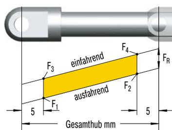
$F_1$  = Nennkraft bei 20 °C
