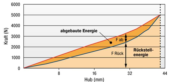
Anhand der Auswahldiagramme können die Gesamtenergie und deren absorbiertes Anteil ermittelt werden.
