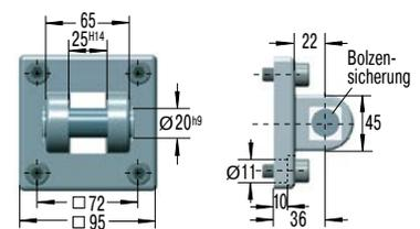
SF64 = Flansch + 4 Schrauben M10x20, DIN 912
