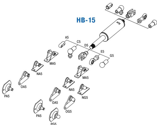
Einstellbar, Druck- bzw. Zugkraft 30 N bis 1.800 N
