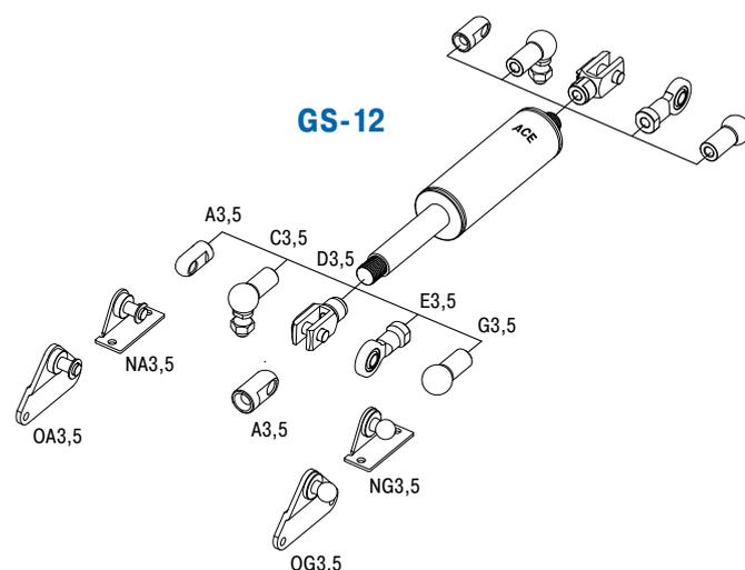
Ventiltechnik, Ausschubkraft 40 N bis 400 N (eingefahren bis 560 N)
