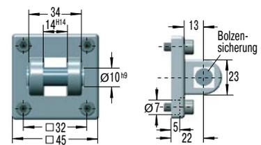
SF33 = Flansch + 4 Schrauben M6x20, DIN 912
