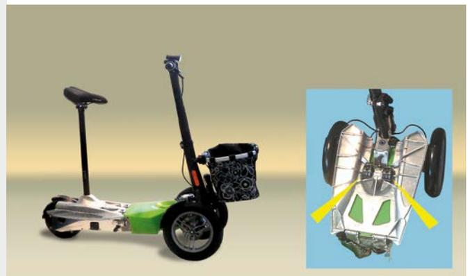
Strukturdämpfer erhöhen Fahrkomfort eines Elektro-Scooters
