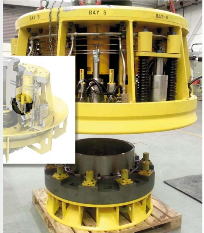
MAGNUMS ermöglichen zur Not schnelle Trennung der Pipelines von Bohrseln
