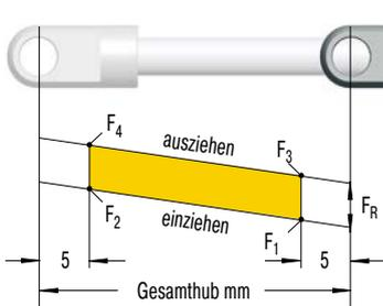
$F_1$  = Nennkraft bei 20 °C
