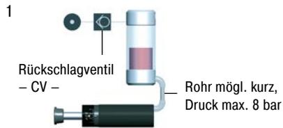
Die Kolbenstange wird nach dem Abbremsvorgang sofort in die Ausgangsstellung gefahren. Funktion ohne Netzdruck kurzzeitig möglich.
