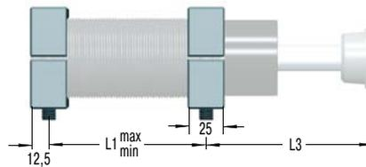
S45 = 2 Flansche + 4 Schrauben M8x50, DIN 912
