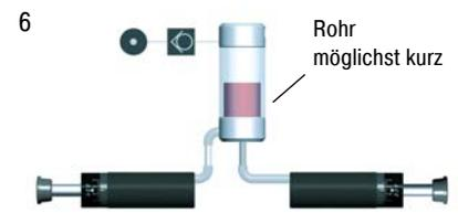
Anschluss von 2 oder mehreren Stoßdämpfern. Nächst größeren Luft-Öl-Tank vorsehen. Kombination mit Beispiel 2, 3 und 5 möglich.
