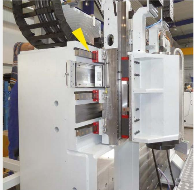
Klemm- und Sicherheitselemente von ACE halten Achsen in Sonderdrehmaschine felsenfest und sichern die zuvor festgelegten Positionen horizontal wie vertikal
