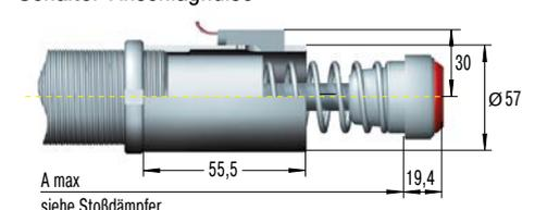
inkl. Näherungsschalter und Schaltkopf mit PU-Einsatz
