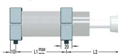
S33 = 2 Flansche + 4 Schrauben M6x40, DIN 912
