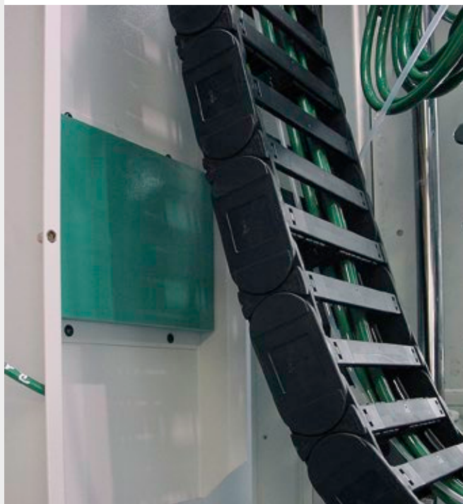
Chaîne porte câbles à faible bruit
