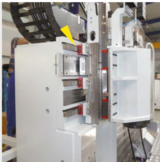
Les éléments de sécurité et les bloqueurs d'ACE assurent un maintien extrêmement solide sur les axes dans des tours spéciaux et respectent les positions prédéterminées horizontalement et verticalement RASOMA Werkzeugmaschinen GmbH, 04720 Döbeln, Allemagne
