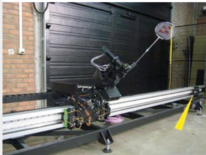
Différents absorbeurs sont utilisés pour freiner les mouvements rapides d'un robot joueur de badminton FMTC vzw, 3001 Leuven, Belgique
