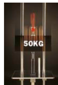
Démonstrateur ACE : chute libre d'un verre de vin d'une hauteur de 1,3 m. Ralenti par un amortisseur sans répandre une seule goutte de vin.
