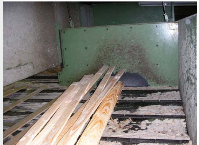
Anschlagsschutz für Holzleisten Stora Enso Timber AG, 2601 Sollenau, Österreich
